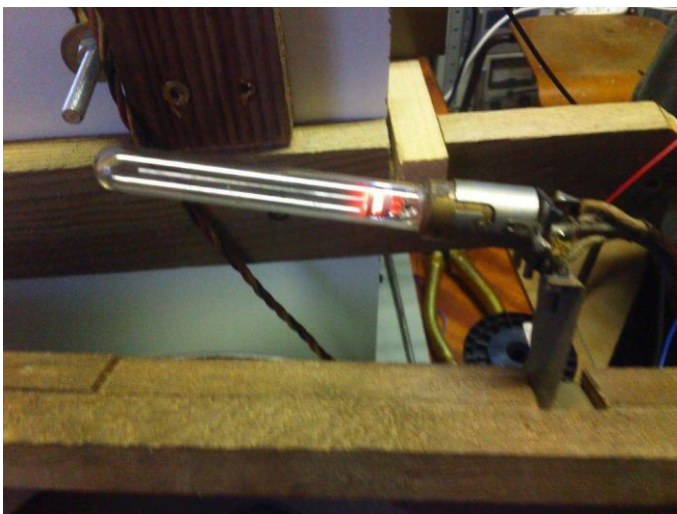
Le tube néon d'accord en fonctionnement
