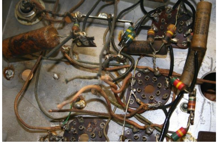
Broken Lug Strip
