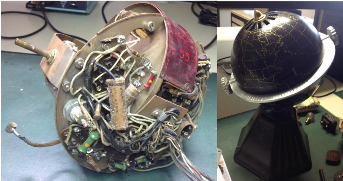
Plusieurs pièces étaient manquantes et du machinage et tôlerie ont été nécessaires pour les reproduire. Le travail est étonnant. De plus, beaucoup de pièces électroniques étaient manquantes et une radio identique d'un ami a dû être empruntée afin de trouver les pièces manquantes et de façonner les autres. Les condensateurs originaux ont été remplis avec de nouveaux.
