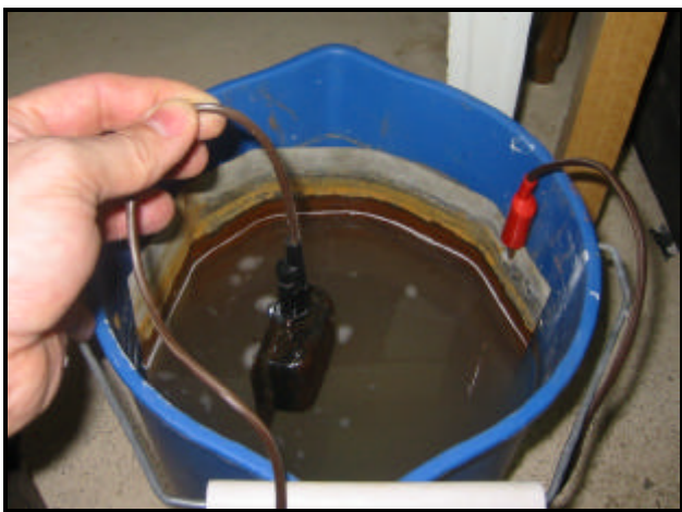
La pièce connectée au négatif (Noir) L'électrode sacrificielle au positif (Rouge)
