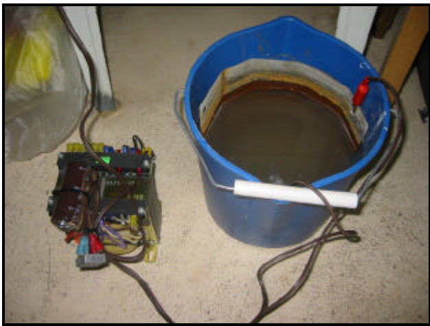
Le chargeur et le bassin d'électrolyse
