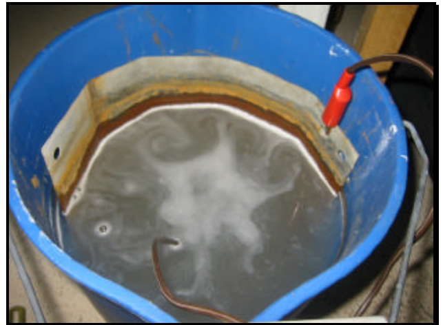
Mise en fonction du chargeur. Notez les gaz qui se forment sur les électrodes.
