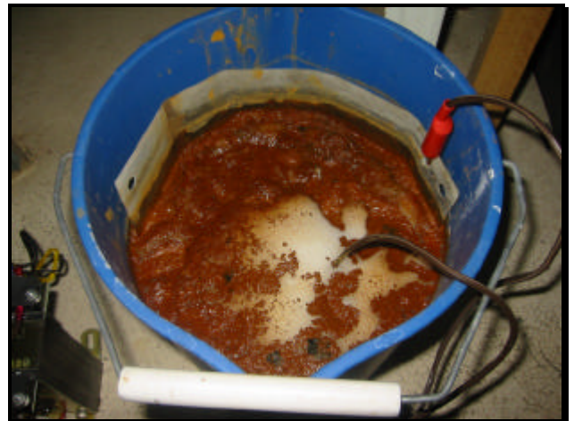
Le bain après 2 heures. La rouille est passée en solution dans le bain puis se dépose en partie sur la pièce de métal positive.
