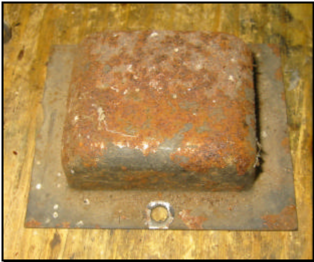
La pièce à nettoyer (Couvercle de transformateur)
