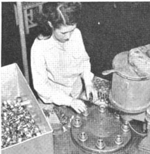
Disposition des bases assemblées pour montage final.
