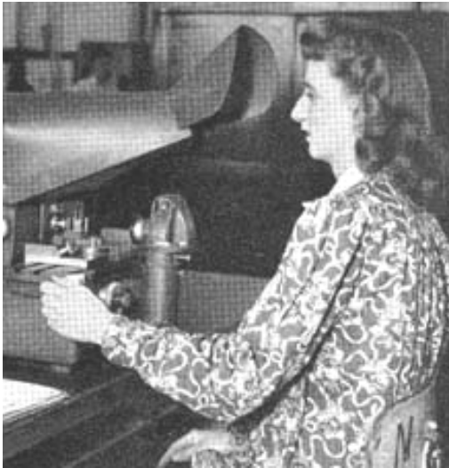
Vérification de la grille sur le comparateur visuel qui l'agrandit 50 fois.
