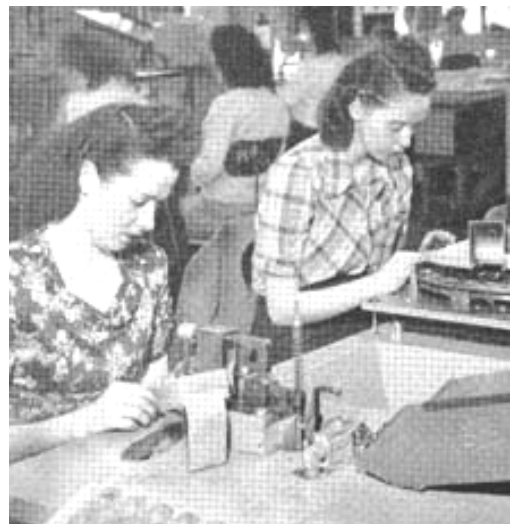
Soudage de la mise à la terre et assemblage de la coquille à la base de bakelite sur laquelle sont montées les tiges de connections.
