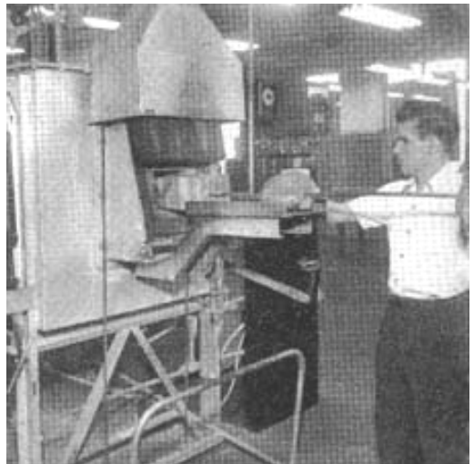
Chargement de la fournaise d'hydrogène qui débarrasse les gaz emprisonnés dans les pièces de métal raccourcissant l'étape d'évacuation.
