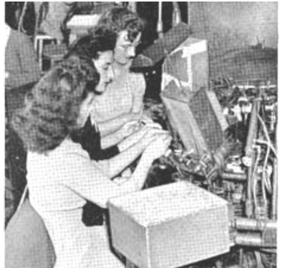
Ici les fils de connections et les tiges de verres sont placées dans la machine à sertir.
