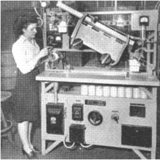
Mesure du diamètre des filaments de tungstène après l'application de l'isolant.
