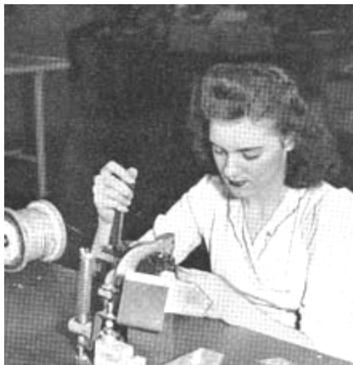
Soudure d'un ruban de nickel au manchon de la cathode.
