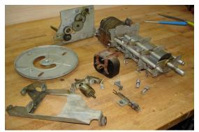
Pour le reste, le châssis a été nettoyé et brossé avec un nettoyant à métal lustré et séché avec un fusil à air chaud.
