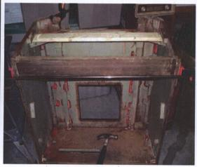
J'ai d'abord commencé par un bon nettoyage en profondeur. Par la suite, j'ai enlevé plusieurs morceaux servants de jointure afin de les recoller et de les revisser.
