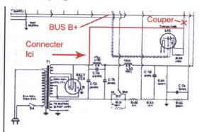
Pour obtenir une tension de cible encore plus élevée, on peut utiliser un petit circuit composé d'une diode au silicium 1N4007 et d'un condensateur de 10 à 22uF, 450 volts. La chute de tension dans la lampe rectificatrice (5Z4, 80) est assez élevée, de 80 à 100 volts comparativement à 1 Volt pour la diode au silicium. La tension continue disponible pour l'œil magique sera par conséquent plus élevée.
