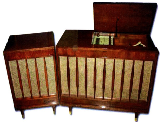
La radio possède 16 tubes avec quatre 6AQ5 en sortie. Un beau projet de restauration pour cet hiver!
