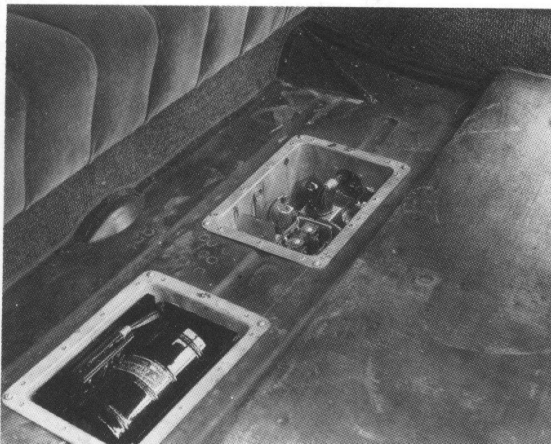
A gauche le dynamotor et à droite le bloc d'alimentation dans le plancher derrière le siège avant.
