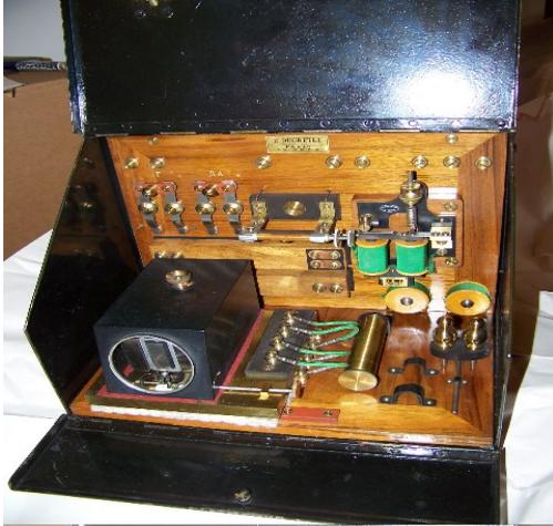
Vous pouvez y admirer des appareils uniques tels un appareil de télégraphie de marque Ducretet, fabriqué en France du modèle utilisé pour les premiers essais de transmission en 1898 à partir des installations de la tour Eiffel à Paris, un émetteur à étincelles original fabriqué à Montréal vers 1907 par la Marconi Wireless Telegraph Company of Canada et identique à
