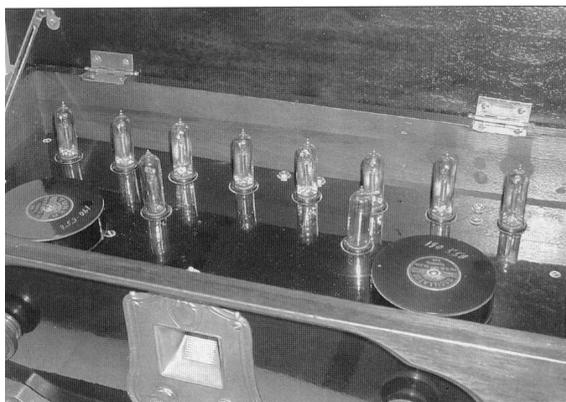
*Le nouveau châssis recouvert de bakelite et avec les bobines sur le dessus et controle unique pour la syntonisation.*
