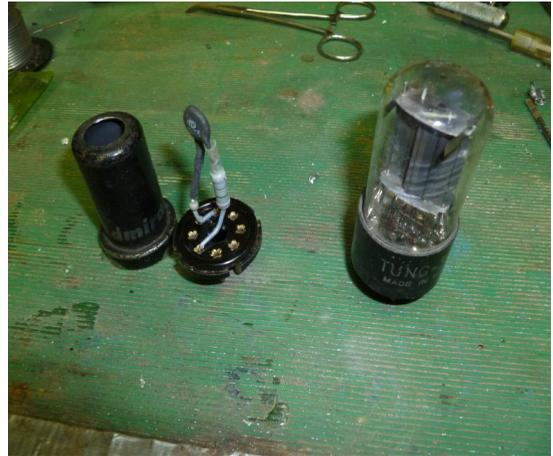
En regardant les diverses photos du montage, on aperçoit les composants qui se logent facilement à l'intérieur du tube. À noter que le filage entre les composants est bien torsadé, pas question de se fier à la soudure pour maintenir nos joints.
