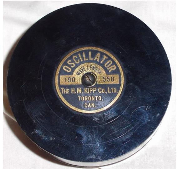
*La bobine interchangeable d'oscillateur pour la bande de 190 à 550 mètres.*
