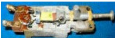
Remplacez l'armature dans le boîtier de la cartouche. Assurez-vous que les supports de l'armature sont correctement positionnés.
