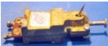
Utilisez de la quincaillerie miniature 2-56 (boulons et écrous) pour tenir le boîtier fermé.
