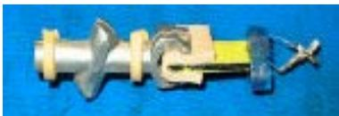
Installez le nouvel élément piézo dans la fourche de l'armature. Utilisez la petite bande de caoutchouc originale ou fabriquez-en une nouvelle à partir d'une bande élastique large.
