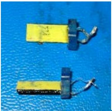
Séparer soigneusement les deux éléments piézo. Les composantes de caoutchouc bleues se coupent très facilement avec une lame d'exacto.
