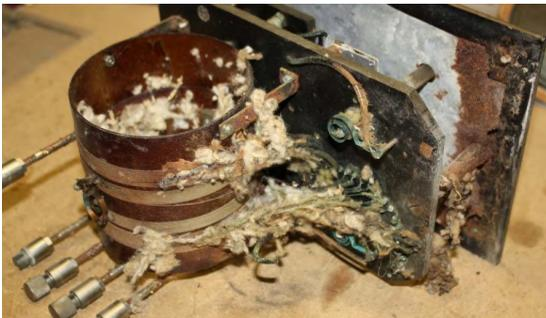
Et voici le résultat, tout ce qui est métallique est profondément oxydé, l'isolant des bobines a été bouffé et tous les contrôles sont
