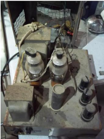
que la table tournante était bonne pour la ferraille. Après m'être assuré que je pouvais mettre l'amplificateur en marche (remplacement de tous les condensateurs, vérification des résistances et des modifications antérieure) j'ai retiré le mécanisme et procédé au remplissage des trous sur le couvercle par soudure à l'arc. L'ensemble avait besoin d'un bon nettoyage et d'une nouvelle peinture.
