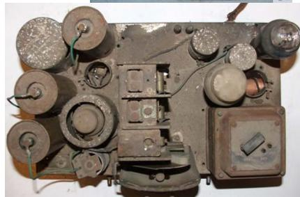
Le châssis entièrement demonté et chaque pièce nettoyé.
