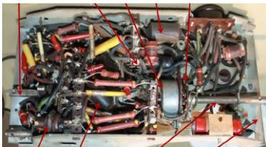
Le chassis a été nettoyé, la corde du symtonisateur remplacée ainsi que le cable d'alimentation par un d'époque.
