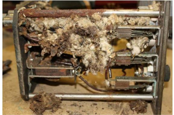
Il a donc fallu tout démonter, nettoyer chaque pièce, réhostats interrupteurs, rebobiner le variomètre, délaminer les transformateurs pour les nettoyer, etc.
