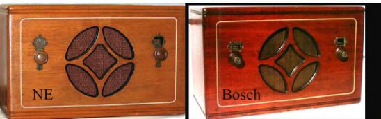
modèle 5, un TRF de cinq tubes et le Bosch modèle 5A, bien que les schémas sont apparemment identiques, le châssis du NE diffère du Bosch, car des tubes 224 ou 235 sont substitués aux 551 avec quelques résistances et condensateurs.
