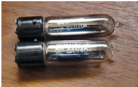
Le R-40 original prenait 45 Volts au B+ du détecteur ainsi que 90 Volt au B+ de l'amplificateur. Dans l'appareil en question, on a lié les deux entrées de B+ et on les raccordait tous à la batterie 45 V. Des photos de l'appareil original
