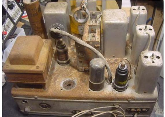
Le cabinet bien que complet a nécessité de nombreuses heures de travail. La toile a dû être remplacée et toutes les étiquettes originales en papier ont été reproduite et collé au châssis après qu'il ait subit un nettoyage en profondeur et été repeint.
