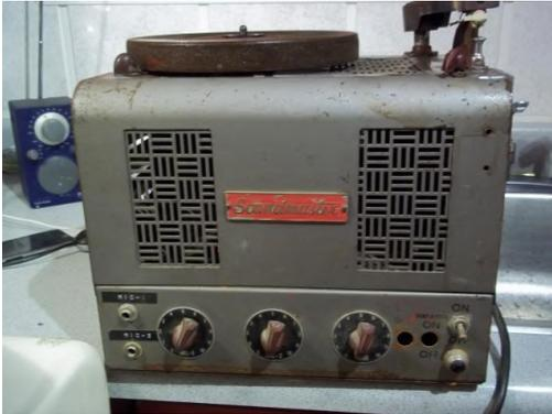
s'agit d'un P.A. ("public address" afin d'amplifier des microphones, utilisé dans des foires, petits spectacles, etc.) de marque Soundmaster 700 fabriqué en Ontario en 1951. Il possède deux entrées microphone, un ajustement "tone", deux tube RCA 807 en "push-pull" fournissent la puissance à des haut-parleurs qui peuvent avoir une impédance de 4 à 500 ohms. L'état général était plutôt déplorable. Suite à une inspection plus approfondie, je n'ai pu que constater
