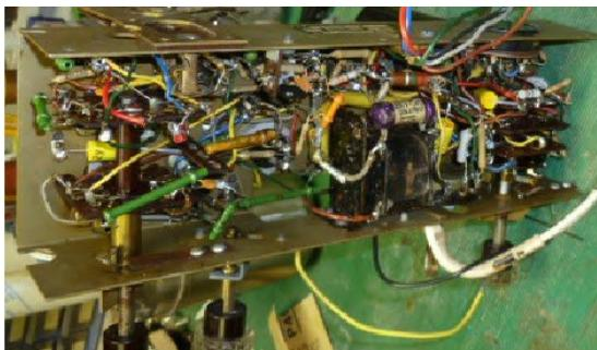
foutu le camp avec ce nouveau transfo. Le support de bobine et les pièces dans le circuit d'injection ont du être changées. Finalement au pif, le tracking ressemblait à l'original.
