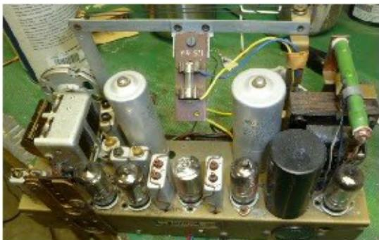
Dans les châssis de radios portatifs pour pièces, un petit Marconi avait des bobines de la bonne dimension pour entrer dans le châssis compact du Philips. Cette bobine de remplacement était destinée à marcher avec une 1R5 et une section du condensateur variable plus faible que le côté signal. La situation dans le Philips était différente, la DK92 est une variante de la 1L6 et la section du c.v. pour l'osc. est de 400 pf, la même valeur que du côté r.f.
