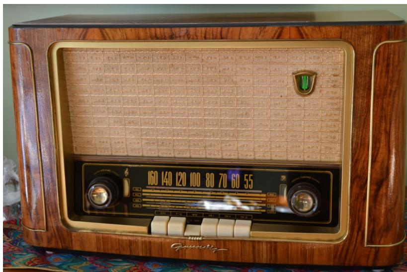
Voici des photos avant et après la restauration du Grundig 2045WZ, un récepteur AM avec deux bandes d'ondes courtes. Le boîtier a bénéficié d'une excellente restauration par Daniel Labelle et Ken Lyons a remplacé tous les condensateurs et le sélénium sous le châssis. Le client a été enchanté par le résultat, de plus l'ajout d'un transmetteur AM avec récepteur FM intégré rend cet appareil très agréable à écouter.
