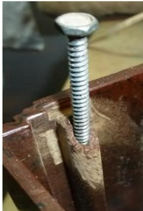
reil de plastique ou de bakélite avec un point d'ancrage brisé comme à droite? Et voici le travail ! C'est solide et vite fait.
