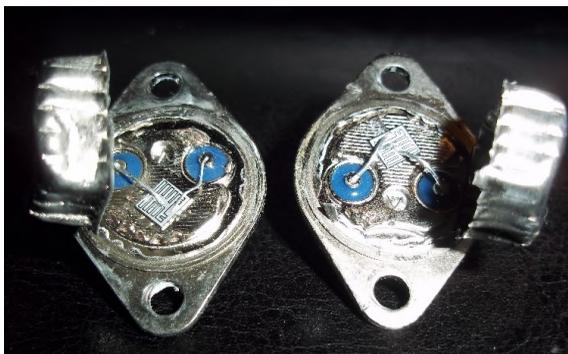
Voici la vraie construction d'un original. Remarquez la construction robuste, la dimension de la pastille et le métal épaissi autour du semi-conducteur (proviennent d'un autre projet).
