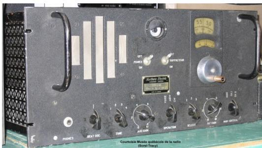
Un examen détaillé révèle un étage de RF avec un 6SK7, un mélangeur 6A8 avec un oscillateur 6J5, deux 6K7 pour amplificateurs d'IF, un 6B8 détecteur, AVC et ampli audio, suivi d'une sortie de puissance 6F6 avec un 5X4 comme redresseur et un œil magique pour la syntonisation. Il comporte un 2<sup>e</sup> 6B8, un 6N7 et un autre 6J5 qui ont demandé un dépistage afin de déterminer leurs fonctions. Un cristal de 4.980 kHz est aussi présent, son
