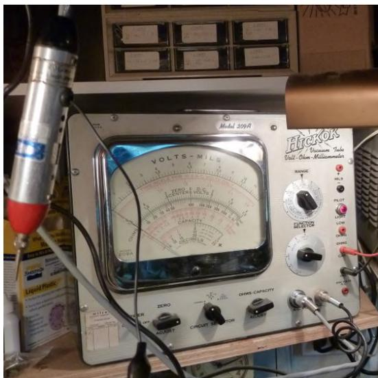
Daniel Labelle de Lasalle a fait l'acquisition de ce multimètre Hickock 209A restauré avec sa sonde HF munie d'une 6AL5.
