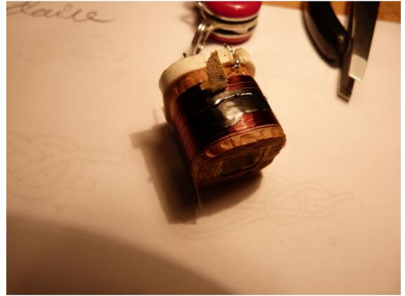
*Le fil de cuivre de l'enroulement après la réparation. J'ai installé un petit morceau de ruban électrique en-dessous de la soudure pour donner une isolation avec les tours de fil adjacents au joint. Les pinces à cils ont été très utiles pour faire le joint dans le fin fil de cuivre.*
