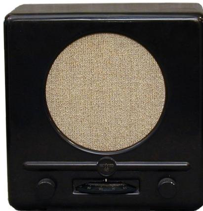
secteur AC ou DC de 110V à 240V et un récepteur à batterie. Le tout-courant utilise 2 lampes, une VCL11, triode-tétrode avec chauffage à 90V et une VY2, redresseur à simple alternance avec chauffage à 30V. Les filaments sont reliés en série avec une résistance chutrice à prise intermédiaire permettant l'usage sur les différents voltages du secteur. À noter qu'aucune compensation n'est faite pour le haut-
