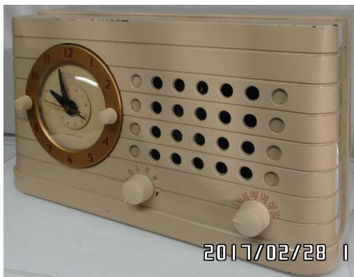
C'est un radio de 1946 en **bakélite** brun ou **bakélite** peint blanc. Manufacturé par Telechron Inc, Ashland, Mass.. TRF à 4 tubes. 35W4 (Rect.), 12SG7 (RF), 12SQ7 (Det.), 50L6 (Audio), AM 550-1600 kHz.
