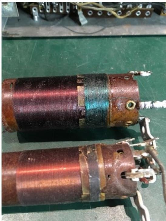
Il y a juste 50 tours à faire, mais à la main et avec un calibre 38 awg c'est une bonne tâche. J'ai sortis du boîtier, les deux transformateurs puis installé un nouvel enroulement. Ensuite je les ai réinstallés dans le boîtier. Avec la mise en tension, tadam le radio fonctionnait plutôt bien. Il restait juste un enlignement à faire. Je vous montre une photo avant et après. Dans la photo les deux bobines ne sont pas identiques, mais vous voyez le principe.
