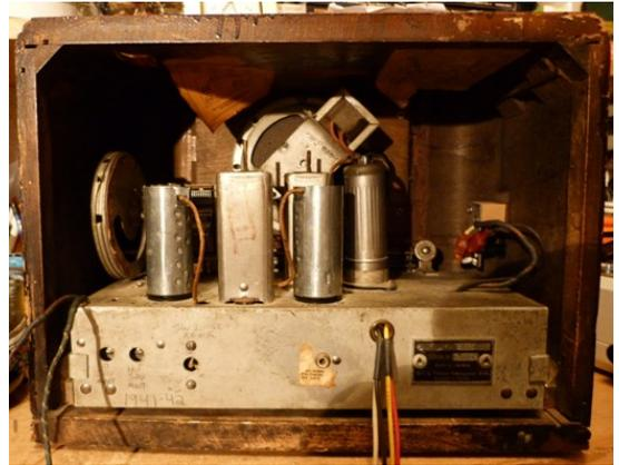
*Vue arrière du récepteur B63. Les deux blindages de tubes en avant-plan ont été fabriqués par moi, puisqu'ils étaient absents lors de l'acquisition de l'appareil. J'ai aussi eu à installer un contrôle de « tone » (à droite) qui était manquant.*
