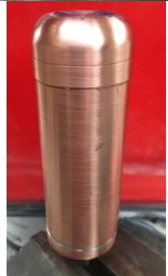
Dans le cas d'un cylindre d'aluminium, la façon de faire est encore beaucoup plus facile. La procédure est plus courte que la première. Pas de trou, aucune soudure à faire, juste deux petites coupures. Dans cette technique, je coupe au-dessous de la partie du haut et la tige du bas. Je vide le condensateur de son contenu.
