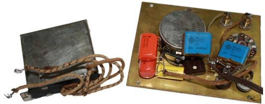
La chance me sourit ; je trouve le schéma de l'appareil à la fin d'un recueil de schémas de radios Philco des années trente. Je m'en doutait bien mais je confirme ainsi que c'est un pont qui permet de comparer la valeur du condensateur inconnu avec un des trois condensateurs étalons de l'appareil. Je n'ai pas d'autres indications sur son mode de fonctionnement alors je devrai expérimenter et réécrire le mode d'emploi.
