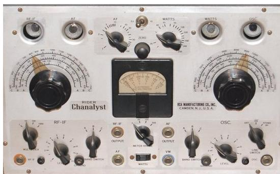
Une innovation pour l'époque, au centre trône un voltmètre à tube d'une impédance de 11 megohms par volt, dont le zéro est au centre du cadran permettant ainsi de lire en positif ou négatif. Donc le voltmètre est suffisant pour vérifier le fonctionnement d'un oscillateur, mais pas sa fréquence.
