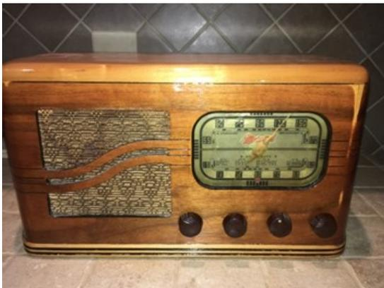
Revenons à ma petite radio. À première vue, la radio n'est pas si mal. Déjà décapée et revernis, un travail de protection mais non de restauration. Après avoir sorti le châssis du meuble et en faisant une inspection rapide de la radio, je me suis aperçu tout de suite que les deux transformateurs IF étaient manquants. Le condensateur variable, qui devrait avoir deux partis, en avait juste une. La deuxième section de ce variable avait été enlevée, arrachée!
