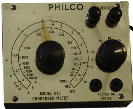
Arrivé à la maison, je commence la chirurgie exploratoire. Pas grand chose à l'intérieur. Un commutateur rotatif, un potentiomètre et un bloc rectangulaire de ce qui ressemble à des condensateurs. Je défais le tout afin de nettoyer le cadran. Et là tout apparaît. Il s'agit d'un appareil pour mesurer la valeur d'un condensateur. Trois échelles permettent de mesurer à partir de 20  $\mu\text{F}$
