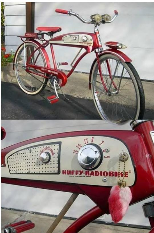
Il s'agit non seulement d'un radio mais de la bicyclette complète avec radio, alimentation et phare avant intégrés. Comme nous pouvons le voir ci-dessus il est muni d'une clef pour éviter que des badauds allume le radio et épuise la batterie, tout comme les premiers radios d'automobile du début des années trente.
