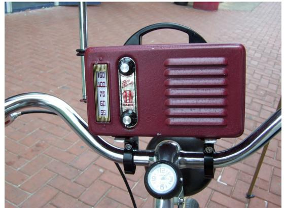
Ce B-150 utilise une pile de 1.5 volt et une batterie de 90 volts.
