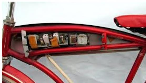
Une vue de l'intérieur avec le couvercle arrière enlevé. C'est un circuit reflex de trois tubes, 1R5, 1U5 et 3V4.
