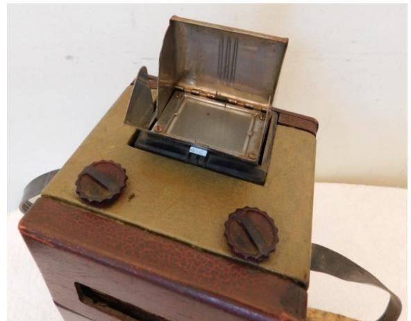
L'appareil très compact loge de l'autre coté le récepteur radio. Les contrôles de contact, volume et syntonisation sont sur le dessus et le cadran de syntonisation sur la face arrière.
