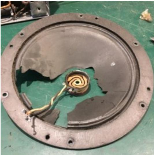
Pour le haut-parleur de 25 cm de Marconi, la procédure est légèrement différente. Comme on voit sur la première photo, le cône est détruit sur le pourtour de la suspension.
