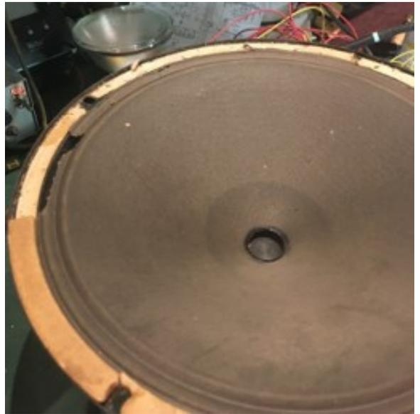
Rien à faire pour une réparation. Le cône est à changer. Parce que les trous des bobines acoustiques des nouveaux cônes sont de plus grande dimensions je garde la partie centrale de l'ancien cône. Comme l'on voit sur la photo ci-contre.
