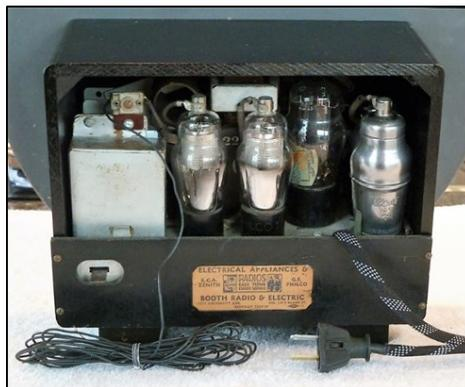
Le cabinet est plus petit et nous voyons à gauche le sélecteur de bande. Pour retirer le châssis il y a trois vis en dessous et les quatre vis maintenant la plaque arrière à enlever.
