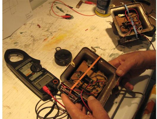
Après avoir examiné les 2 appareils il a réussi à me faire parvenir un circuit électrique de branchement (voir PDF). Originellement, deux piles rondes #6 en série (3 volts total) alimentaient chaque station et un long fil électrique double assurait le branchement entre les appareils. En Avril 2018, Ken m'a remis les artefacts sans avoir eu le temps de les tester. Les retraités actifs n'arrêtent pas...
