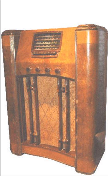
Crosley "The Patrician" 1939, modèle 1940 avec châssis Mohawk, Broadcast-shortwave 4 bandes, phono input, IF456Kc, 6sa7, 2 x 6sk7, 6SQ7, 5Z3, sortie push-pull 2 x 25L6
