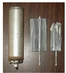
Voici un condensateur à électrolytique liquide, à gauche le condensateur, au centre une électrode saine à droite une électrode après que se soit évaporé l'électrolyte.
