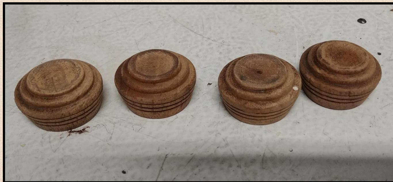
Lorsque j'ai démonté le châssis de mon radio j'ai été très étonné de constater que les 'bushing' de caoutchouc qui sont entre le châssis et la base du cabinet était en très bon état malgré toute les années. Elles sont encore très flexible et pas dutout sec comme la plupart des 'bushing' de châssis de cette époque.
