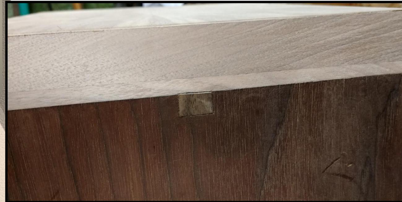
Sur la photo de droite on voit le nouveau placage sur le dessus une fois fini et une réparation mineur sur le coté
