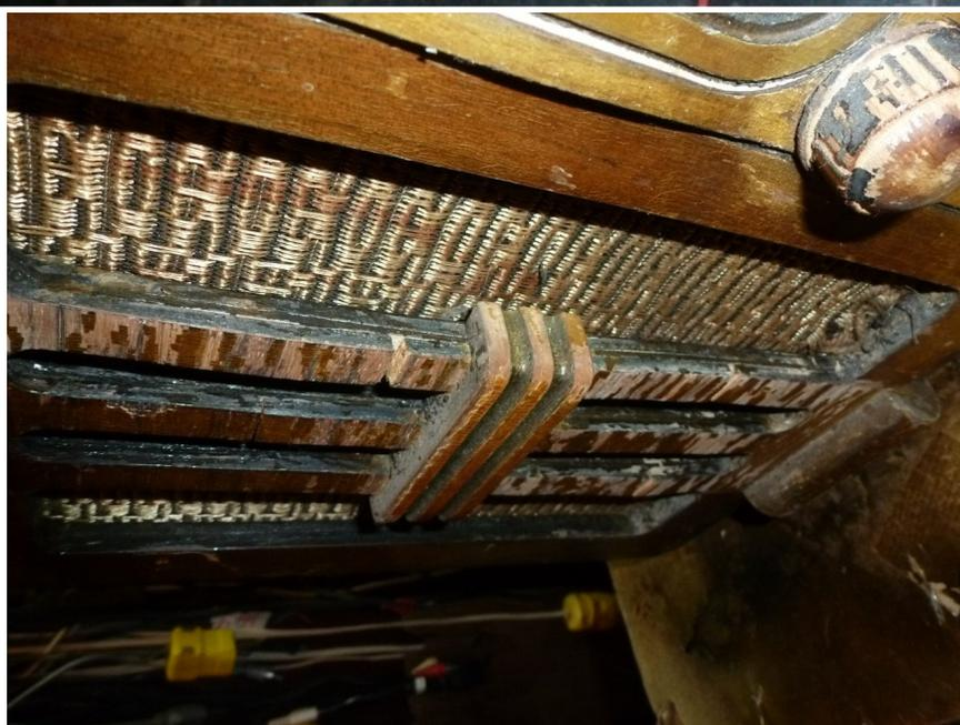
Pour coller la devanture j'ai dû mouiller et chauffer le placage avec un fer à repasser chaud pour le ramollir et lui redonner forme avant d'appliquer la colle et ensuite appliquer les serres.
