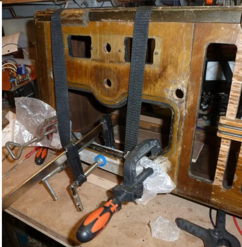
Pour rectifier les quatre couches de substrats délamинées je les ai mouillées avec un jet d'eau et ensuite avec un antique fer à repasser bien chaud j'ai serré le tout avec une serre pour une heure. Ensuite j'ai enlevé fer et serre puis j'ai injecté avec une seringue de la colle sous chaque couche de substrat et j'ai serré.
