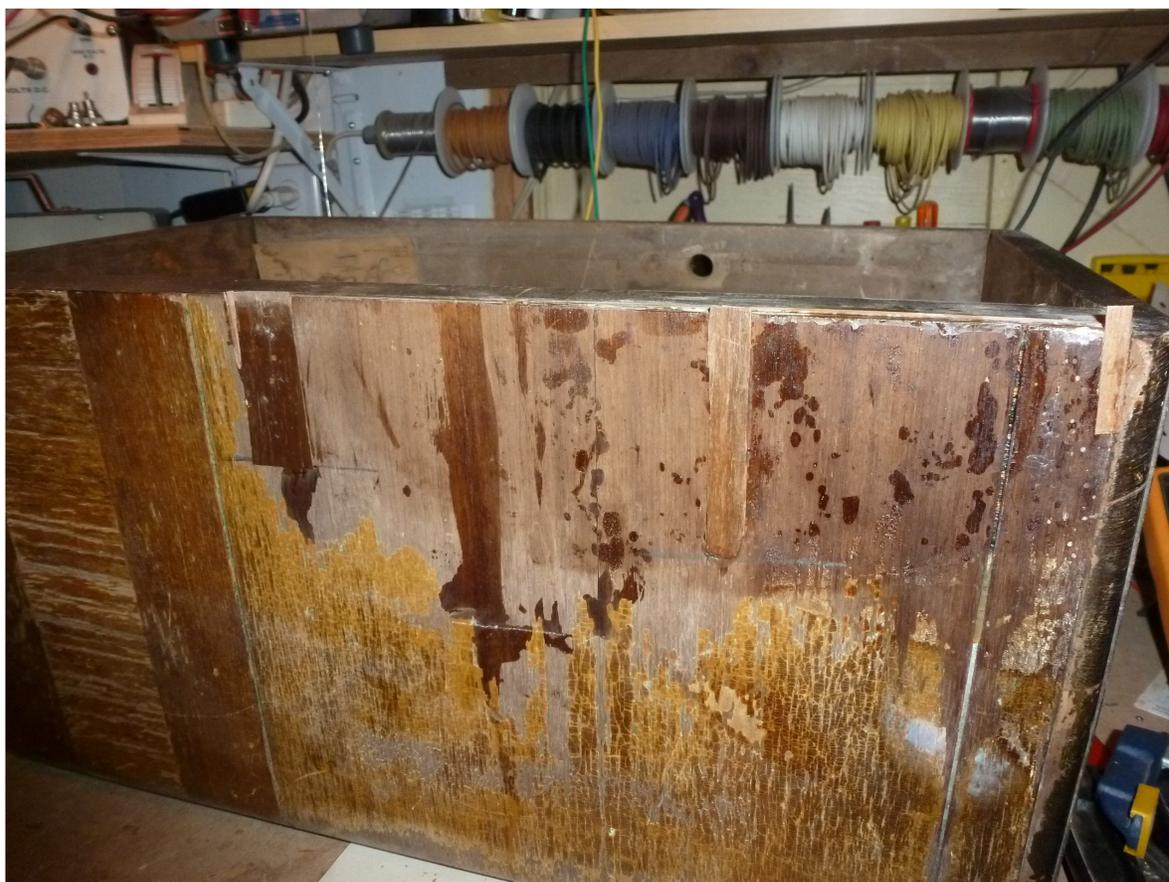
A suivi un sablage du dessus et de la façade. Les barreaux délaminés devant le haut-parleur ont été recollés, en travaillant deux autre morceaux se sont détaché, je les ai recollé et deux petits morceaux manquants ont été fabriqués, on voit bien la marque, quatre taches un peu plus foncée.
