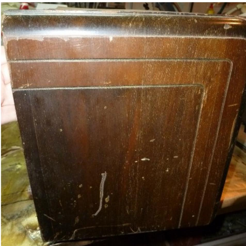
Le placage de la devanture est décollé presque partout le placage étant courbé il n'a pas résisté à l'humidité et il en manque quelques morceaux. De plus les barreaux devant le haut parleur sont délaminés et il en manque deux morceaux.
