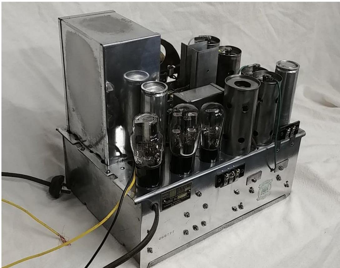
Figure 23 Le cordon d'alimentation a été remplacé avec un fil en tissu
