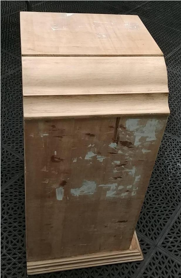
Figure 30 Une fois le cabinet sablé, les trous et imperfections ont été comblés avec un bouche-pores
