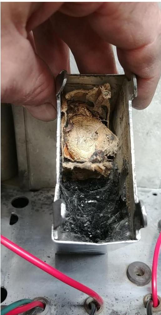
Il y avait aussi, en plus des électrolytiques du dessus, un 'capacitor pack' de forme rectangulaire contenant 3 électrolytiques. Je l'ai démonté du châssis, vidé en partie pour faire place au nouveaux condensateurs et réinstallé le tout à sa place.
