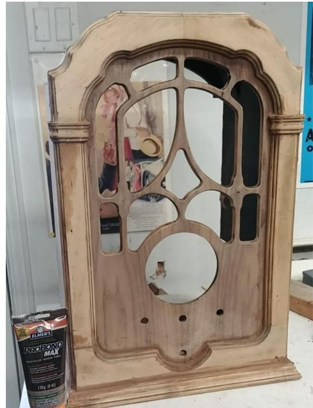
Figure 37 Moulures réinstallées, j'ai utilisé du bouche-pore pour dissimuler les joints et imperfections.
