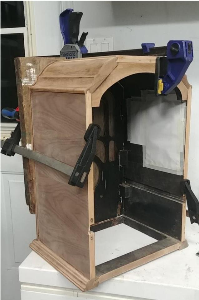
Figure 34 Collage de la façade avec des serre-joints
