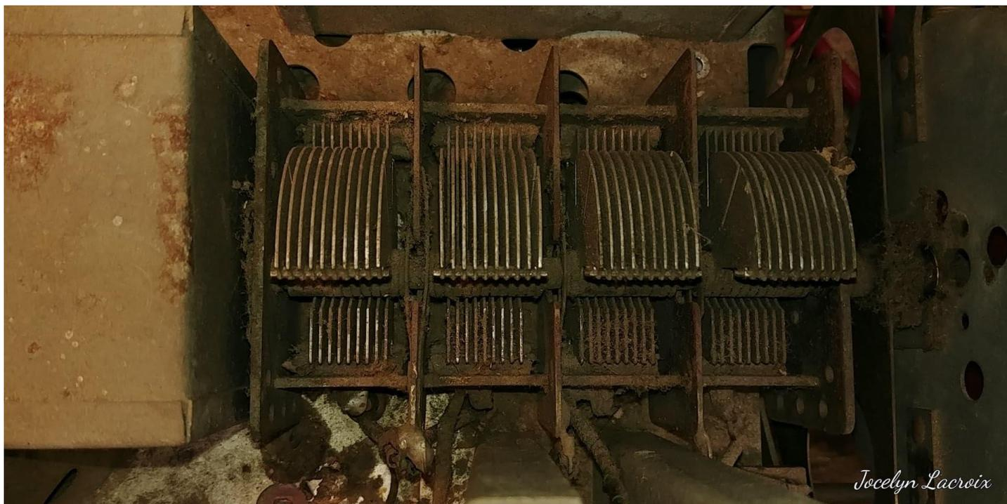
Figure 14 Condensateur variable avant restauration
