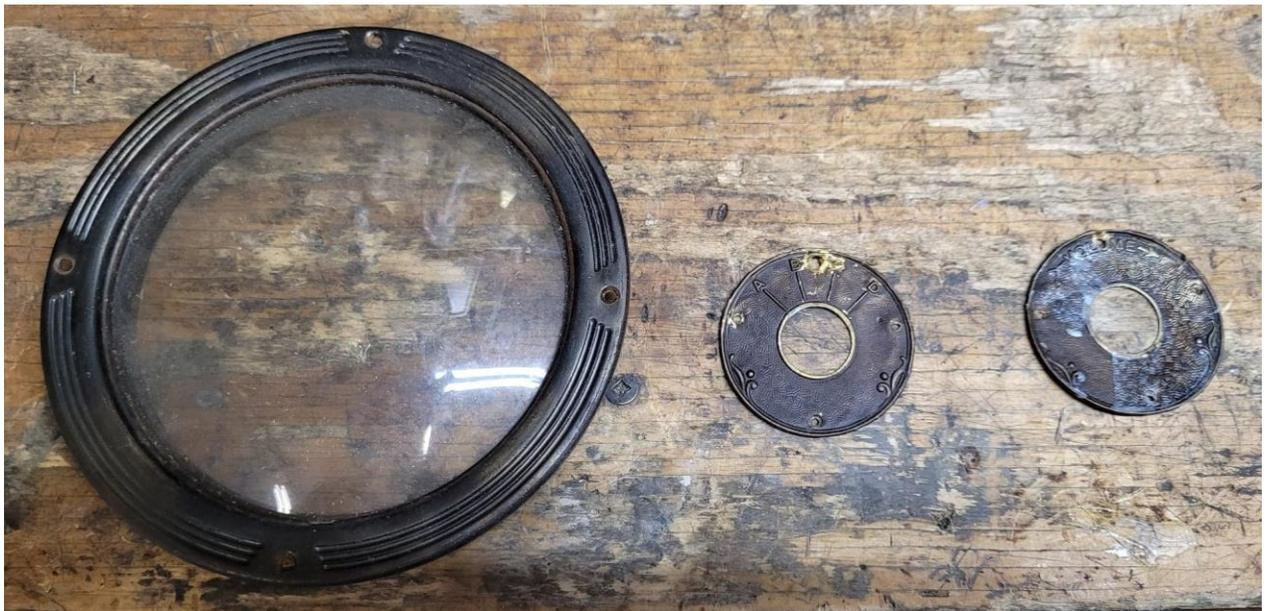
Figure 43 Après la laque j'ai procédé au polissage des pièces de laiton.
