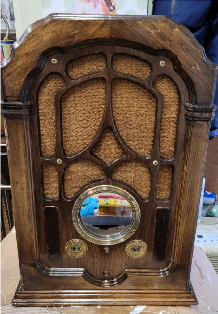
Figure 44 Les pièces de laiton ont été polies avec de l'autosol, deux couches de laques ont été appliquées avant d'être réinstallés. Le tissu du haut-parleur a été délicatement lavé séché puis réinstallé.
