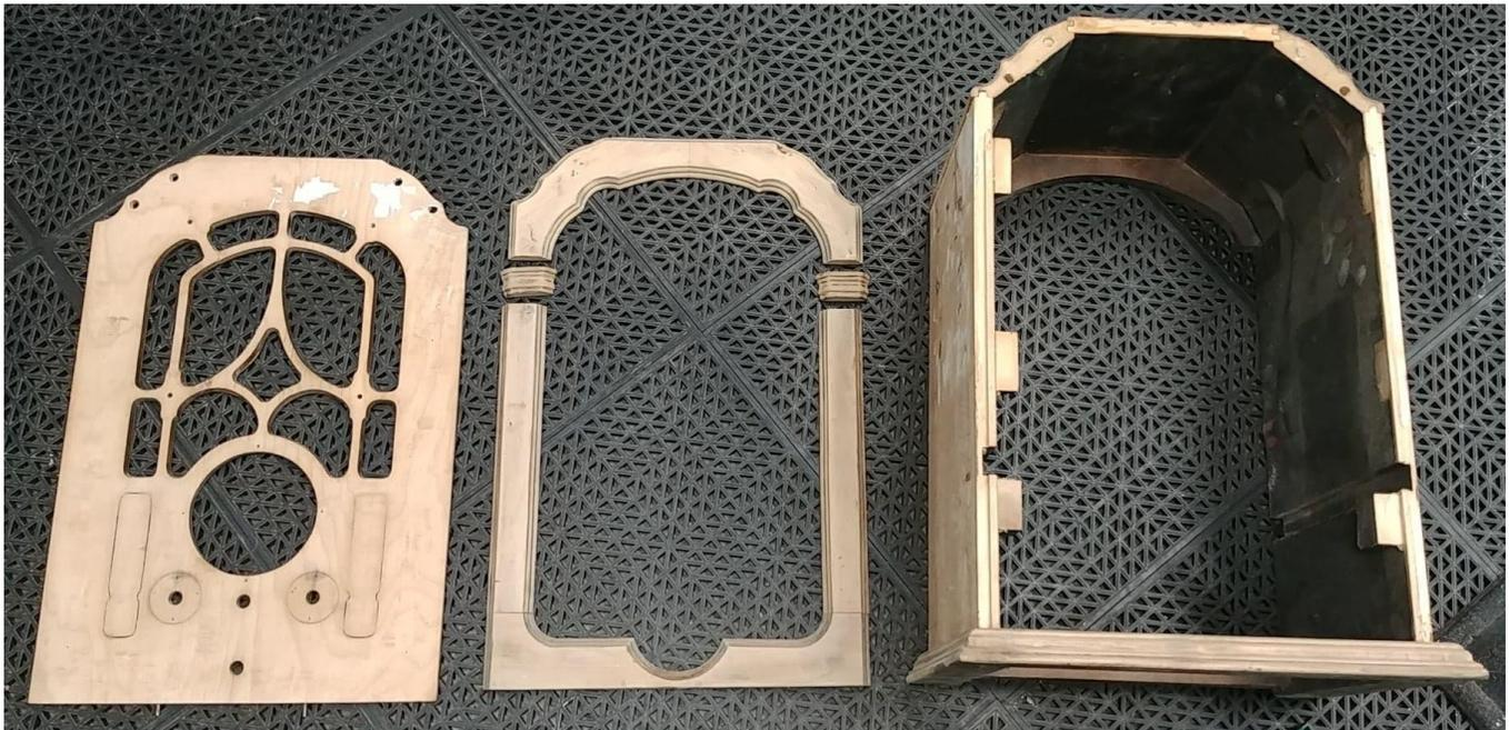
Figure 29 *Les moulures soigneusement retirée et la façade détaché du cabinet et tous les morceaux ont été sablés*
