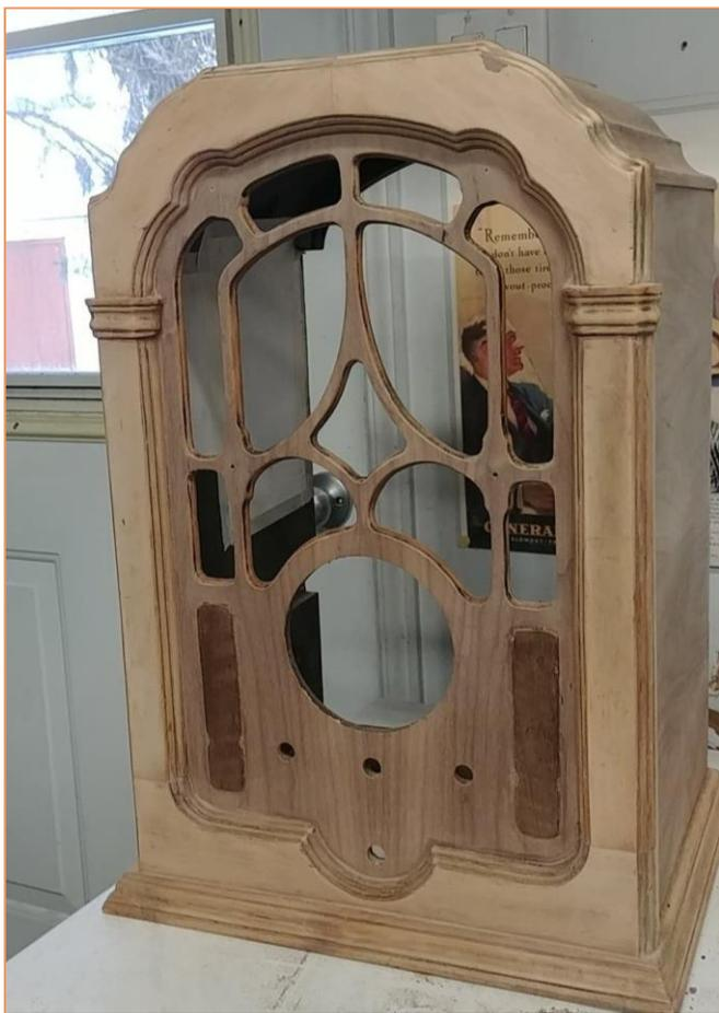
Figure 38 De chaque côtés du cadran il y a un bande décorative de placage que je n'ai pas réussi à reproduire alors j'ai collé les originaux que j'avais conservés juste au cas.
