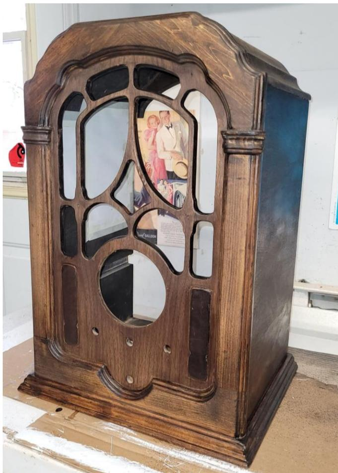
Figure 40 Pour teindre mon radio, j'ai utilisé une teinture à l'huile de couleur Noyer foncé que j'ai dilué avec du varsol pour éclaircir la teinte. Sur les moulures verticales de la façade, j'ai reproduit un dégradé comme à l'origine.
