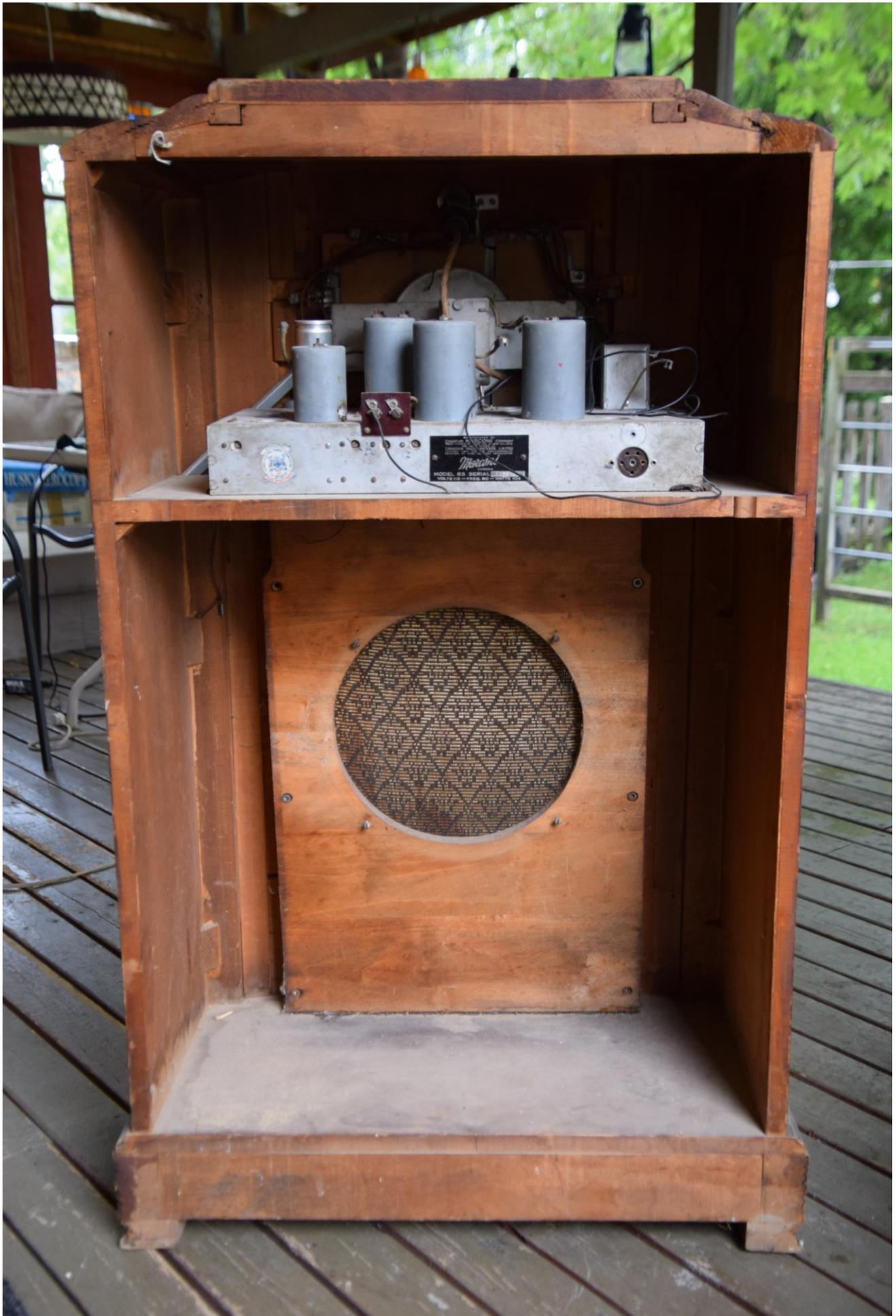
Le châssis en mauvais état est oxydé, sale, les caoutchoucs, le filage sont séchés et il manque des composantes. Le transformateur d'alimentation est manquant. Un deuxième châssis fournira cette pièce, mais elle n'est pas d'origine.
