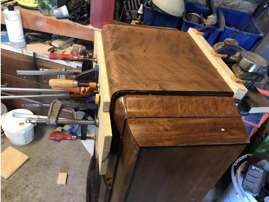
Application du placage, sous serre ici
