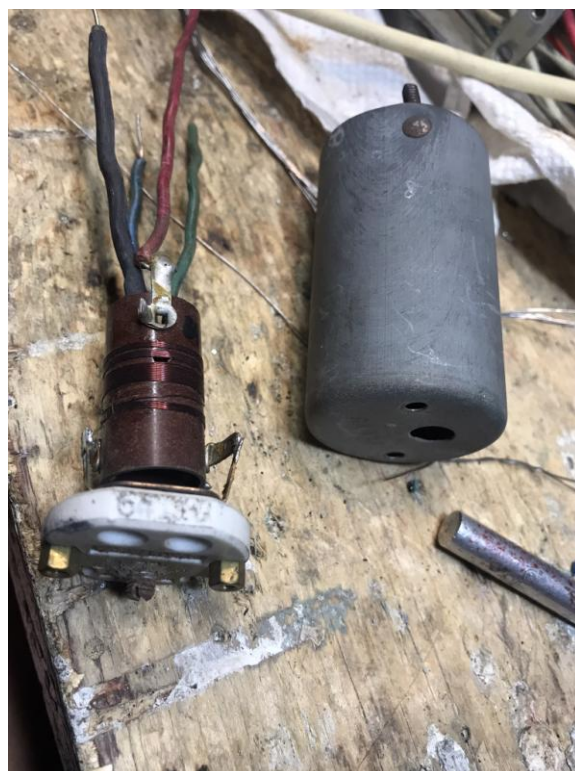
Bobine d'oscillateur récupéré du radio complet
