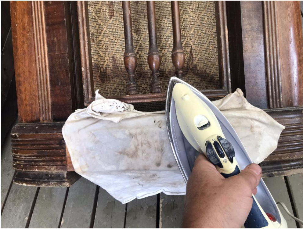
Récupération de pièces de placage de bois exotique du radio donateur.
