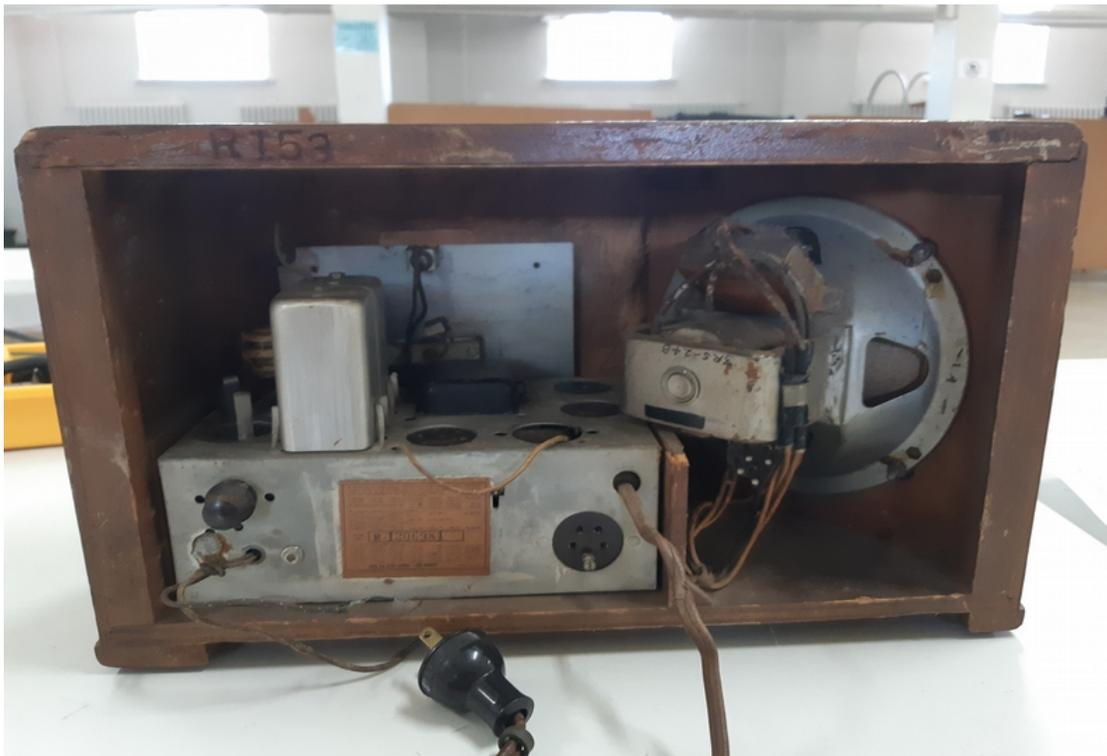
Le boîtier ne présente pas de bris majeurs. Il est décollé à quelques endroits et le fini est abimé au-delà d'une possible récupération. Il faudra donc le décaper et le revernir.
