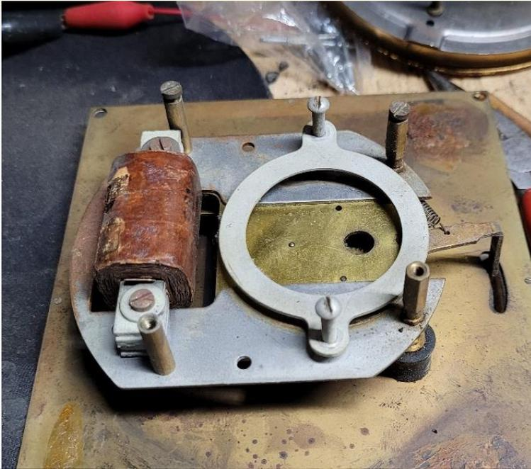
J'ai fait des recherches et j'ai trouvé une horloge de la même époque, soit le début des années 30 et en plus c'est une horloge Westinghouse. Voici donc à gauche le mécanisme de remplacement qui a été extrait de mon horloge 'sacrificielle'
