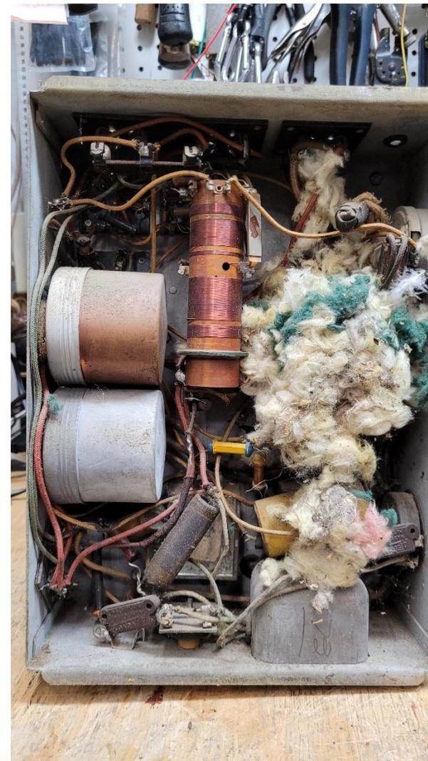
De la rouille partout sur le châssis et aussi sur les condensateurs variables
