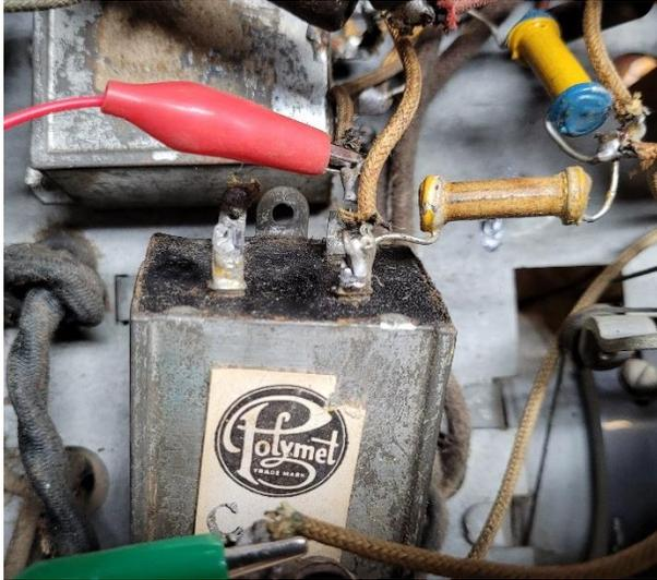
Les boîtiers de condensateurs ont été vidés de leur contenu pour faire place aux nouveaux condensateurs. Les pattes ont été soudées aux terminaux du boîtier. Les couvercles ont été remis en place par la suite. Les condensateurs électrolytiques qui sont situés sur le dessus du châssis dans un boîtier de métal ont tous été remplacés aussi.
