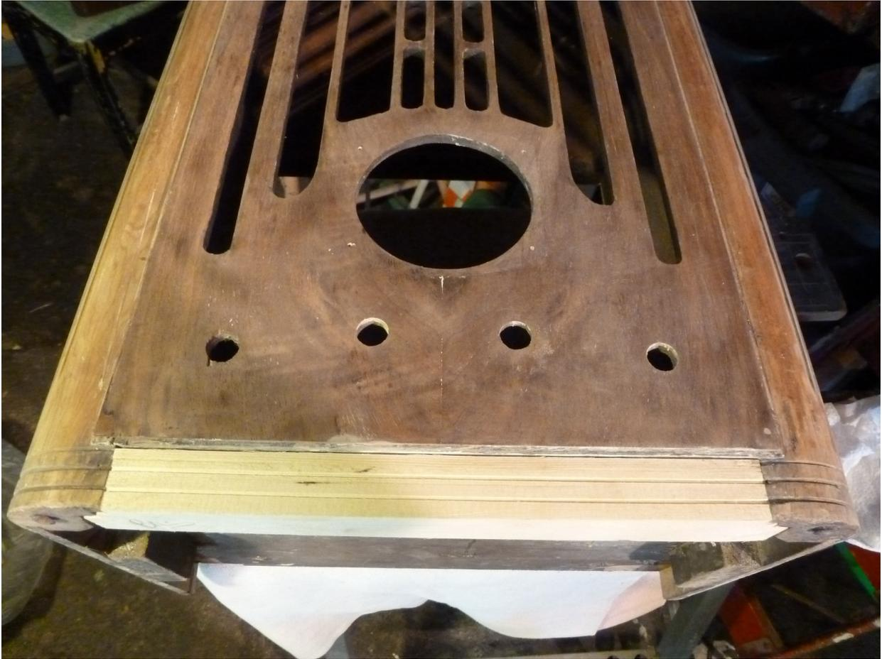
Je n'ai pas décapé le cabinet, j'ai sablé les surfaces plates avec une sableuse rotative, pour les parties courbes j'ai utilisé un grattoir. Ici nous voyons bien la nouvelle pièce au bas du cabinet. Le placage décollé a été recollé et les 2 morceaux manquants remplacés.
