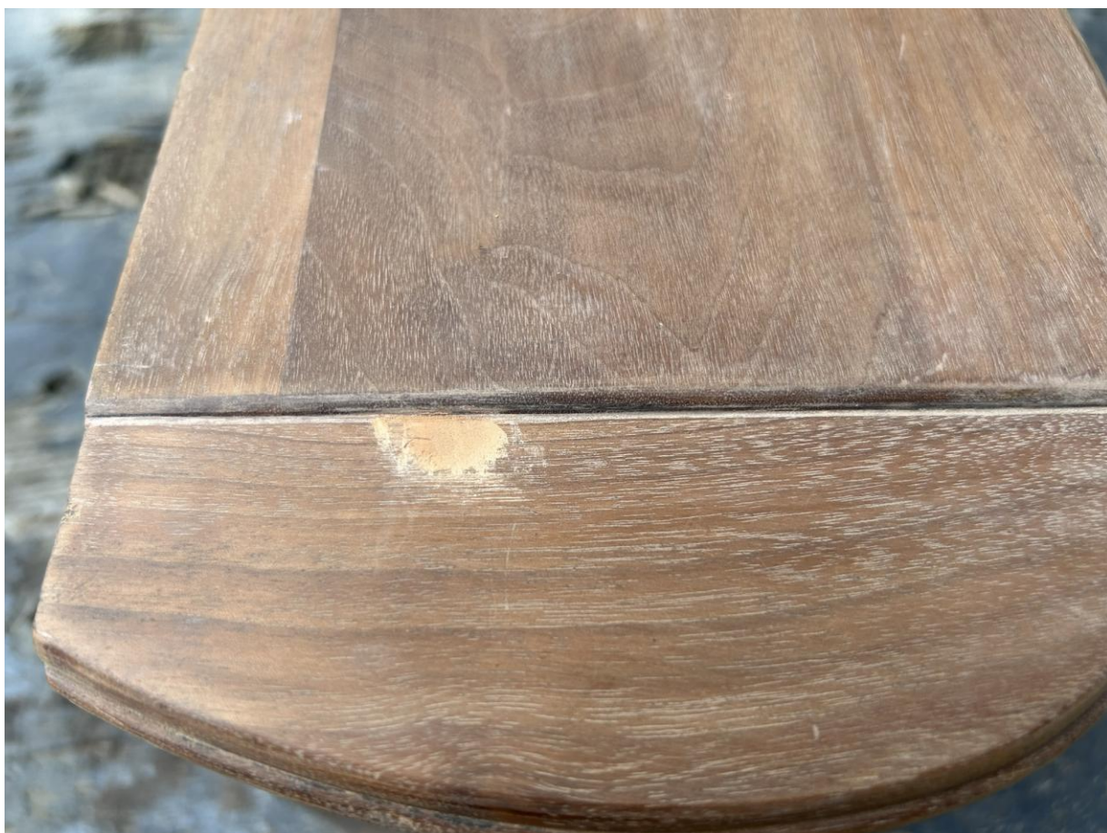
Le dessus, corrigé et le point creux rempli.
